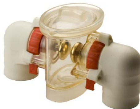
Ячейка объемом 400 мл в сборе (электроды вставлены)
