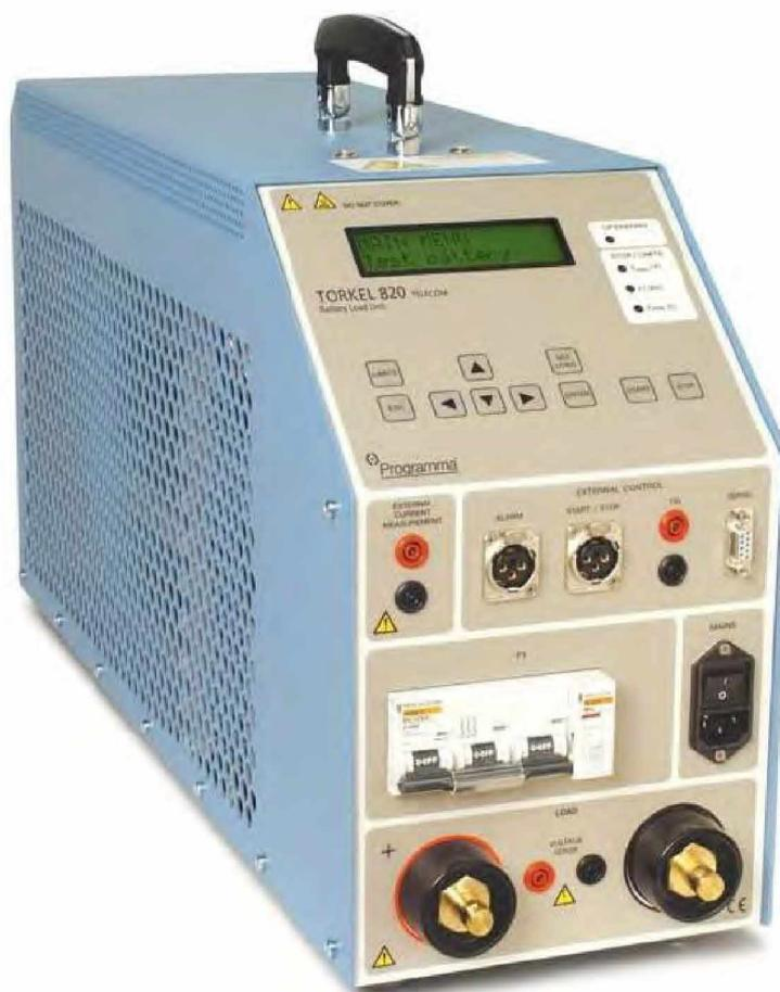
Напряжение, сила тока, время разряда аккумуляторной батареи измеряются и выводятся на дисплей в процессе разряда, и после его остановки по условиям истечения заданного времени или достижения заданного напряжения. По результатам разряда измерители вычисляют емкость аккумуляторных батарей.
