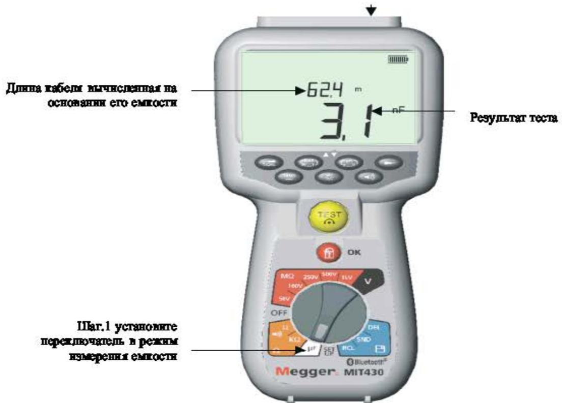
Только приборы MIT 481 и 482 могут вычислить длину кабеля на основании измеренной ёмкости. Длина может выдаваться в футах или км, как заявлено в установках. Установленное среднее значение для расчета длины 50 нФ / км, но может быть изменено пользователем в диапазоне от 40 до 60 нФ / км.
