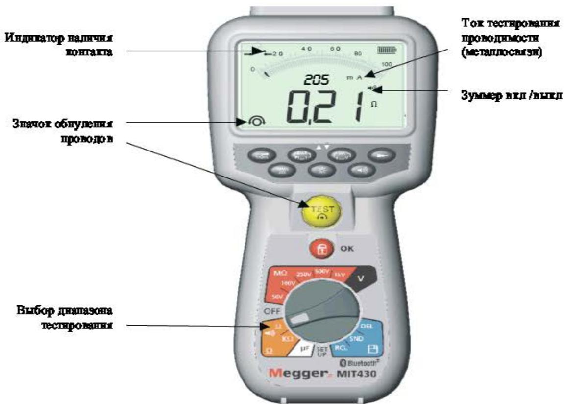
Измерение проводимости производится в автоматическом режиме в диапазоне от 0.00 Ом до 100 Ом на цифровой / аналоговой шкале.
