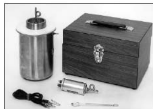
Дополнительная ячейка для тестирования изоляционных жидкостей (масла)
