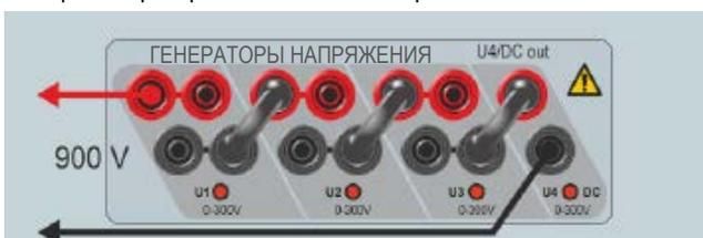
Все четыре генератора напряжения включены последовательно.
