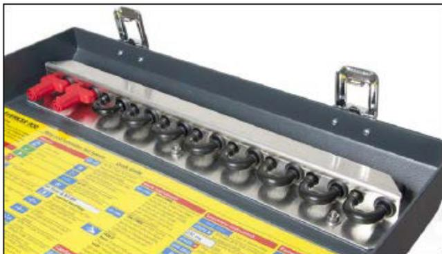
Внутри крышки находятся десять перемычек, установленных в держателях; стилус для сенсорного экрана и руководство по быстрому запуску.
