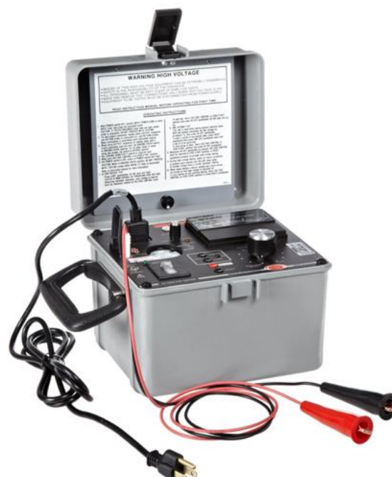
Hipot tester с высоковольтными проводами
