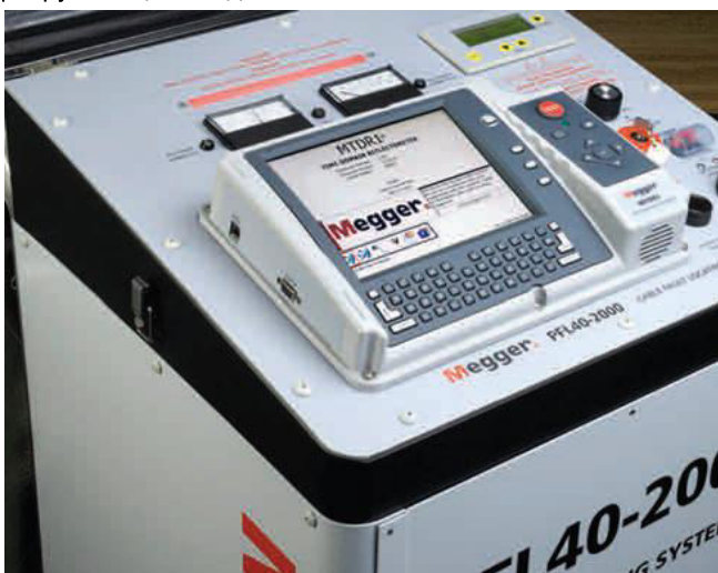
MTDR, смонтированный на установке для поиска повреждений кабеля Megger PFL40A
