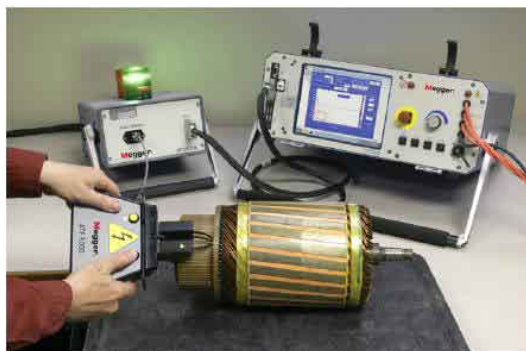
Приспособление Baker ZTX, используемое вместе с анализатором AWA -IV и вспомогательной принадлежностью для испытаний коллектора ATF5000
