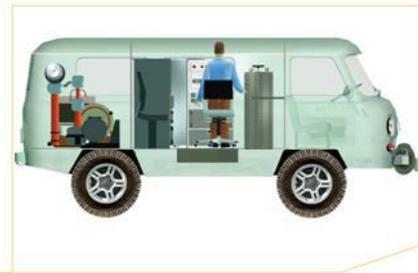
Передвижная лаборатория диагностики высоковольтных трансформаторов предназначена для проведения комплекса работ по испытаниям и диагностике силовых трансформаторов согласно регламентирующего перечня испытаний силовых трансформаторов РД 34.45-51.300 «Объем и нормы испытаний электрооборудования» при вводе их в работу и в процессе эксплуатации:
