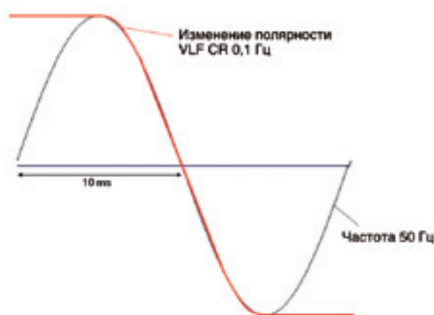
Изменение полярности косинусно-прямоугольной формы напряжения СНЧ
