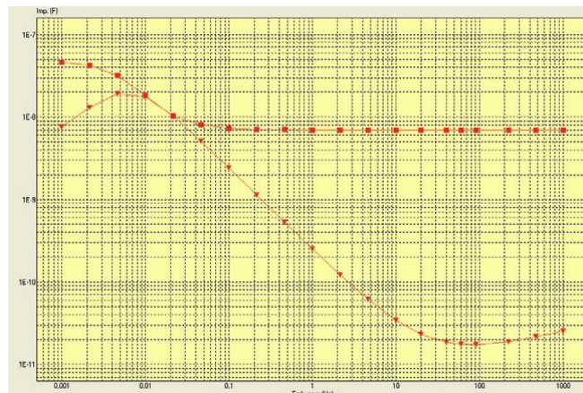
Рис. 2. Кривая коэффициента мощности – в виде зависимости емкости и потерь от частоты
