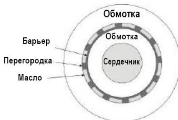
Рис. 3. Типичная структура изоляции
