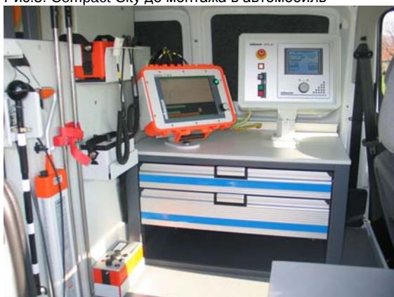
Рис.4. Control-Unit установки SPG 40 и рефлектометр Т 30-Е
