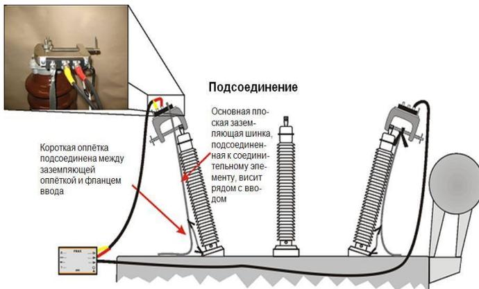
Ноутбук может быть с сенсорным экраном, и подключаться к FRAX 99 с помощью USB-кабеля. Измерительную шинку заземления, для подключения кабеля к фланцу, необходимо подключить близко к соединительному зажиму и пустить рядом с вводом для того, чтобы избежать петли, которая, в противном случае, влияет на измерения.
