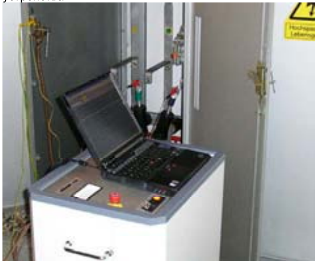
Рис. 6: Установка CDS при полевых измерениях
