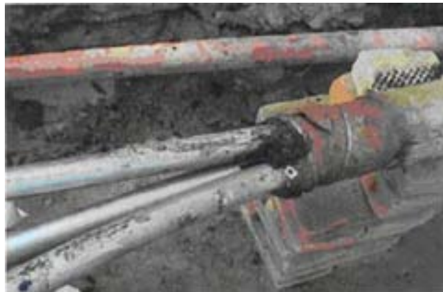
Рис.2: Коррозия внешней оболочки и локальная коррозия свинцовой оболочки
